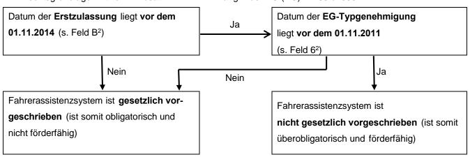
Die VO fordert in Einklang mit den UN/ECE-Regelungen lediglich ein Notbremssystem-Assistenzsystem, welches das allgemeine Sicherheitsniveau anheben soll (z. B. AEBS oder ABA). Daher entfällt die Beurteilung der Förderfähigkeit auf das Zulassungsdatum bzw. das Datum der Typengenehmigung des Fahrzeuges bei den Notbrems-Assistenzsysteme 2, 3 und 4.
